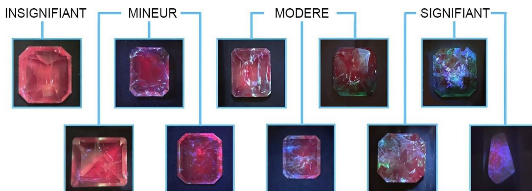
Émeraudes sous lumière ultraviolette. Les fissures bleues révèlent la quantité d'huile.
